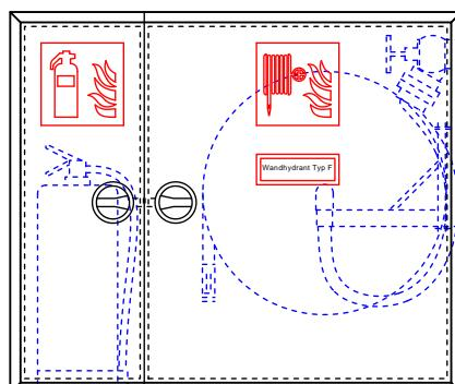
Wandhydrant gemäß DIN 14461-1, Typ F mit Schlauchhaspel gemäß DIN EN 671-1, Aufputzschränk Bauart C mit formbeständigem Druckschlauch an Schlauchanschlussventil C zur Selbsthilfe oder zur Löschwasserversorgung der Feuerwehr.
