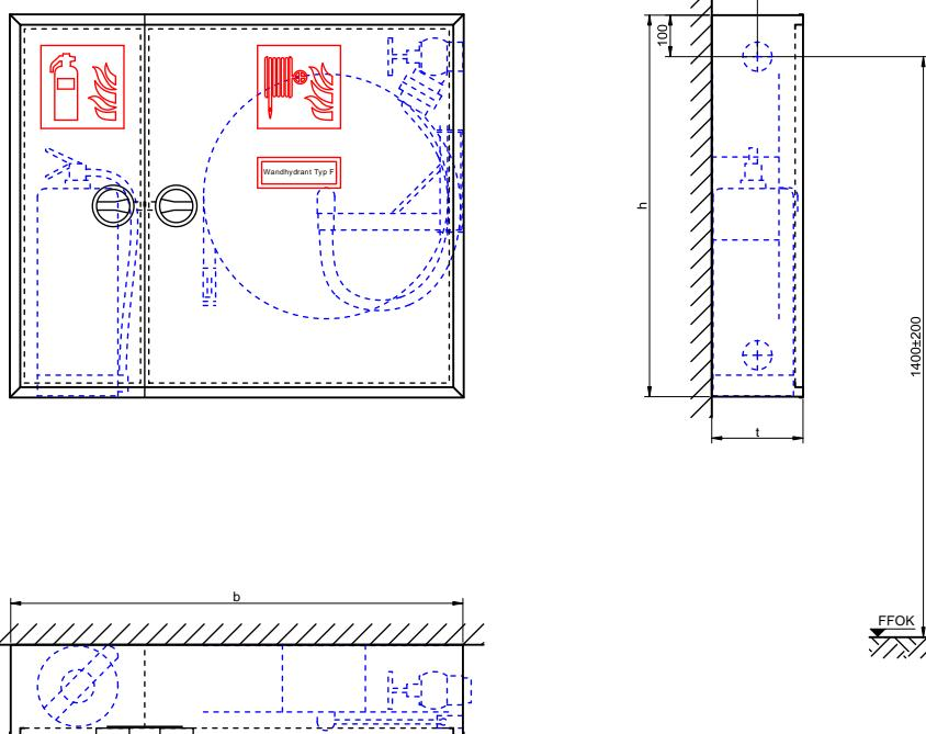
Wandhydrant gemäß DIN 14461-1, Typ F mit Schlauchhaspel gemäß DIN EN 671-1, Aufputzschränke Bauart C mit formbeständigem Druckschlauch an Schlauchanschlussventil C zur Selbsthilfe oder zur Löschwasserversorgung der Feuerwehr.
