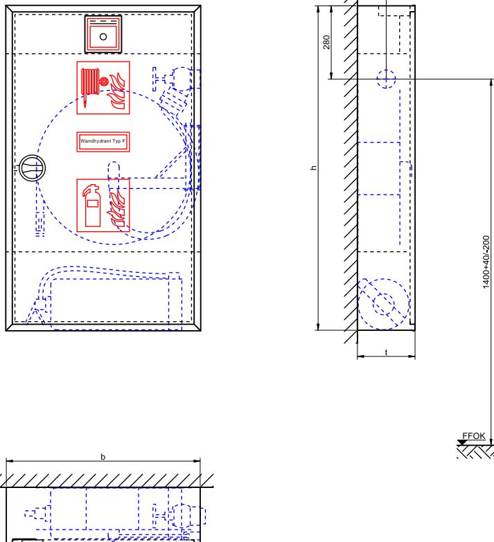
Wandhydrant gemäß DIN 14461-1, Typ F mit Schlauchhaspel gemäß DIN EN 671-1, Aufputzschränk Bauart C mit formbeständigem Druckschlauch an Schlauchanschlussventil C zur Selbsthilfe oder zur Löschwasserversorgung der Feuerwehr.
