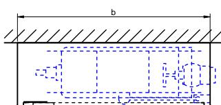
Wandhydrant gemäß DIN 14461-1, Typ F mit Schlauchhaspel gemäß DIN EN 671-1, Aufputzschränke Bauart C mit formbeständigem Druckschlauch an Schlauchanschlussventil C zur Selbsthilfe oder zur Löschwasserversorgung der Feuerwehr.
