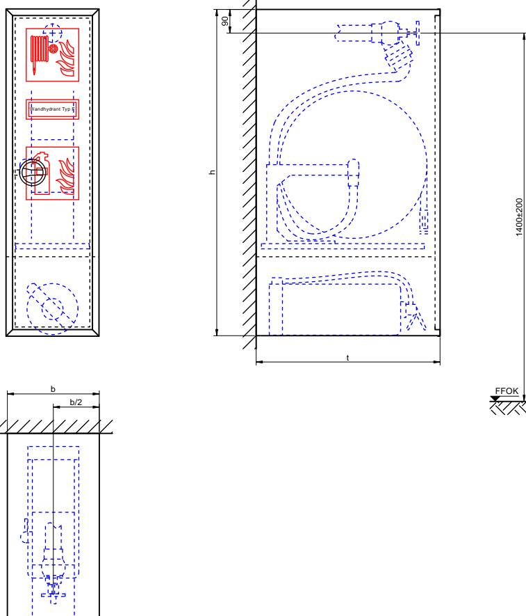
Wandhydrant ähnlich DIN 14461-1, Typ F mit Schlauch-haspel gemäß DIN EN 671-1, Aufputzschrank Bauart C mit formbeständigem Druckschlauch an Schlauchanschlussventil C zur Selbsthilfe oder zur Löschwasserversorgung der Feuerwehr; Schmalhydrant.
