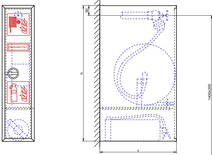
Wandhydrant ähnlich DIN 14461-1, Typ F mit Schlauch-haspel gemäß DIN EN 671-1, Aufputzschränke Bauart C mit formbeständigem Druckschlauch an Schlauchanschlussventil C zur Selbsthilfe oder zur Löschwasserversorgung der Feuerwehr; Schmalhydrant.
