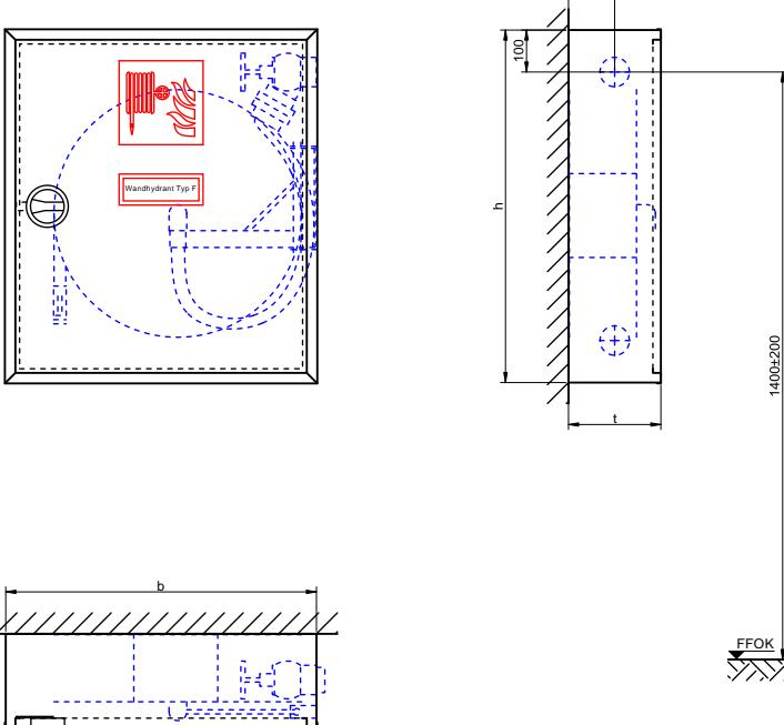
Wandhydrant gemäß DIN 14461-1, Typ F mit Schlauchhaspel gemäß DIN EN 671-1, Aufputzschränke Bauart C mit formbeständigem Druckschlauch an Schlauchanschlussventil C zur Selbsthilfe oder zur Löschwasserversorgung der Feuerwehr.
