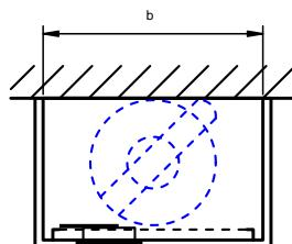
**Schutzschrank zum Einstellen eines tragbaren Feuerlöschers**
