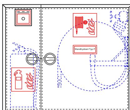
Wandhydrant gemäß DIN 14461-1, Typ F mit Schlauchhaspel gemäß DIN EN 671-1, Aufputzschränke Bauart C mit formbeständigem Druckschlauch an Schlauchanschlussventil C zur Selbsthilfe oder zur Löschwasserversorgung der Feuerwehr.
