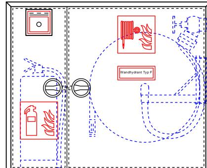
Wandhydrant gemäß DIN 14461-1, Typ F mit Schlauchhaspel gemäß DIN EN 671-1, Unterputzschrank Bauart B mit formbeständigem Druckschlauch an Schlauchanschlussventil C zur Selbsthilfe oder zur Löschwasserversorgung der Feuerwehr.
