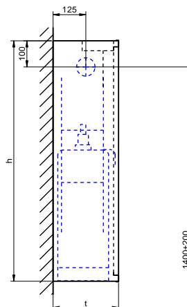
Wandhydrant gemäß DIN 14461-1, Typ F mit Schlauchhaspel gemäß DIN EN 671-1, Aufputzschränke Bauart C mit formbeständigem Druckschlauch an Schlauchanschlussventil C zur Selbsthilfe oder zur Löschwasserversorgung der Feuerwehr.
